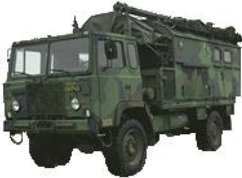
Radiolänkterrängbil 30 med sambandshytt 9001
